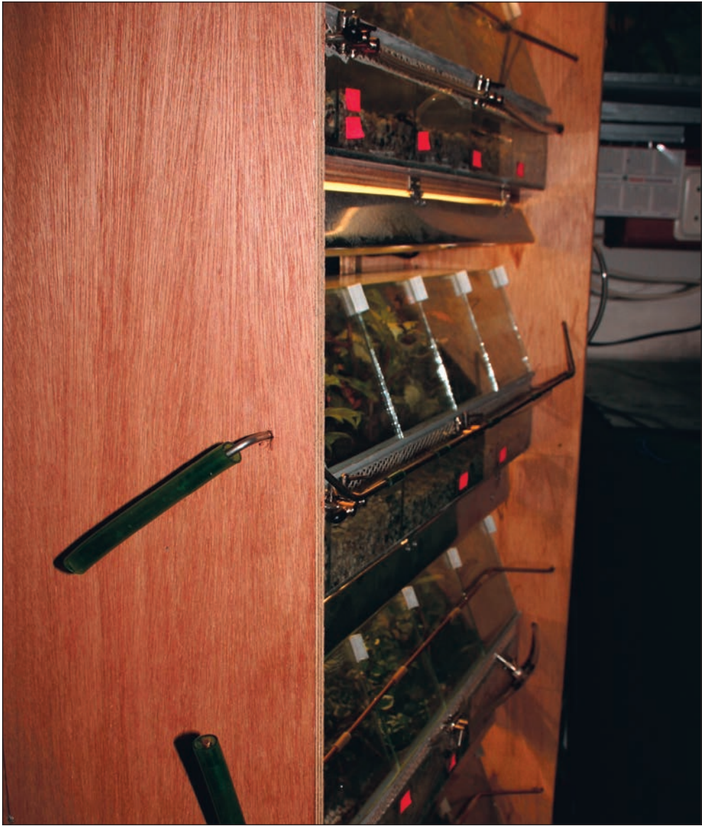
Foto15: Afsluitmechanisme voor opweekunit. De bovenste handgreep wijst naar beneden waarmee de sluiting 'open' staat, de onderste handgreep wijst omhoog ten teken dat de sluiting 'dicht' staat waarbij zichtbaar is dat de sluiting op de klapruitjes rust.
